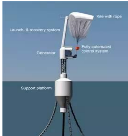
Figura 5: Estrutura do equipamento SkySails
