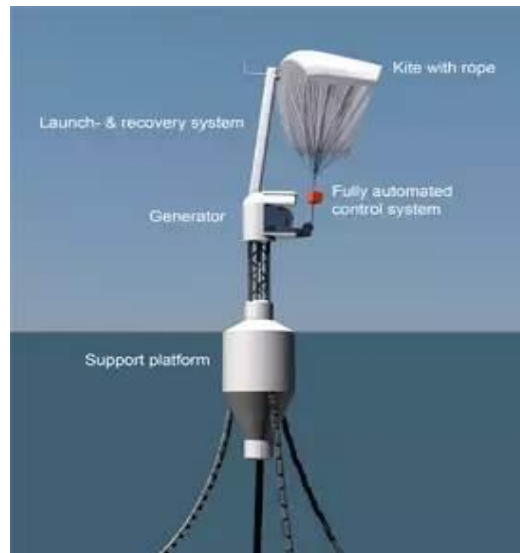
Figura 3: Estrutura do equipamento SkySails
