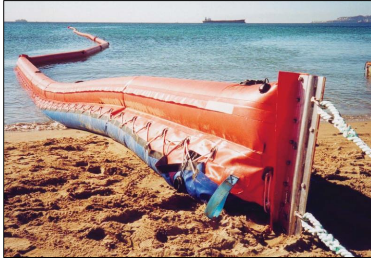
Figura 7 - Barreira de contenção.
