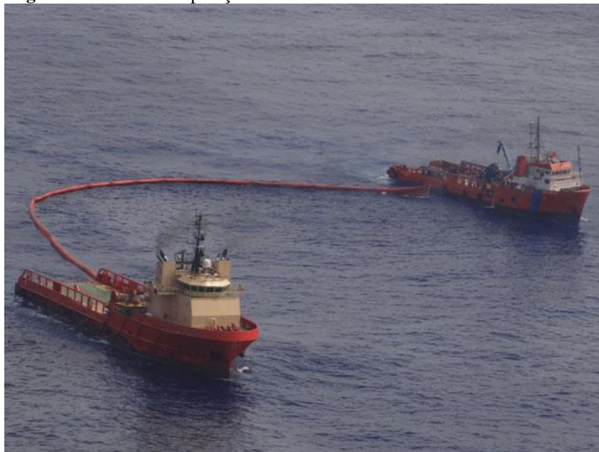
Figura 6 – ORSV em operação.
