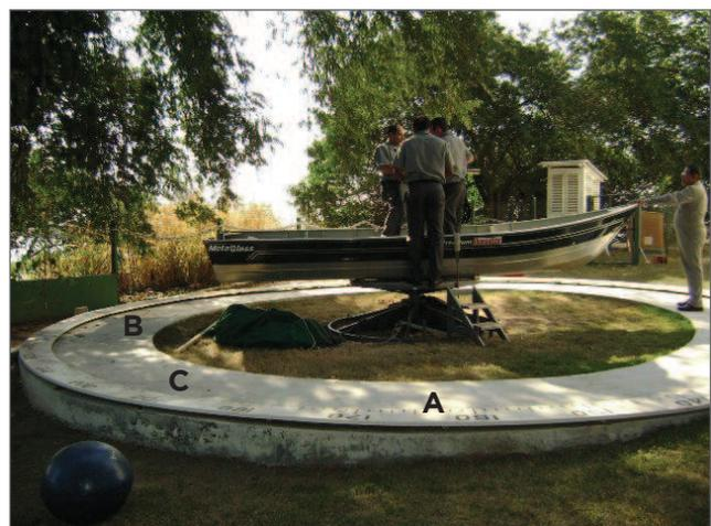
A: base giratória, B: embarcação de alumínio tipo Levefort® de 5 m de comprimento, e C: circunferência graduada sobre rodas, Alidade.
