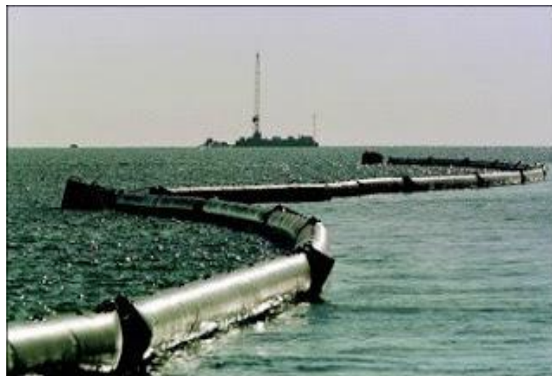
Figura 14 - Boia de contenção
