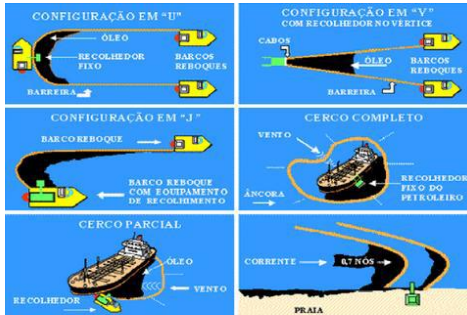
Figura 18: Características Estruturais das Barreiras de Contenção.
