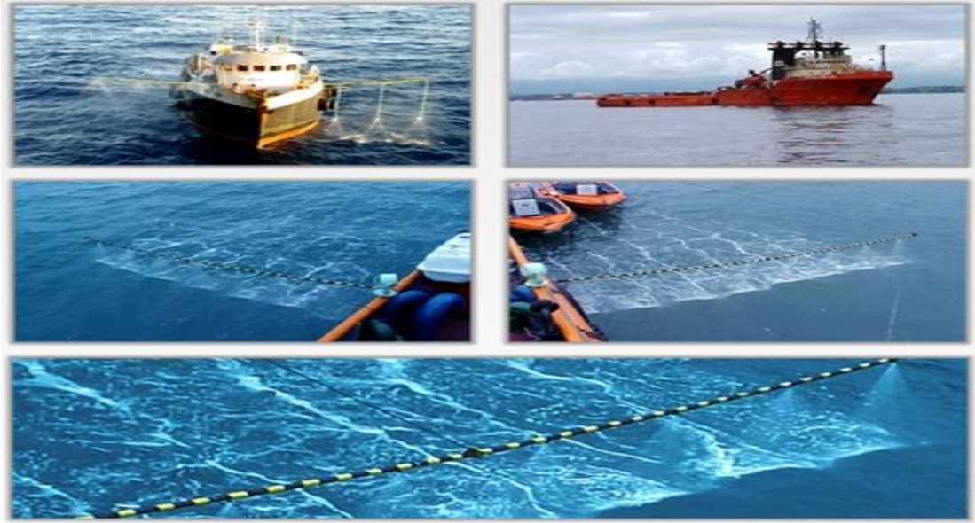
Figura 28: Embarcação lançando dispersante químico.
