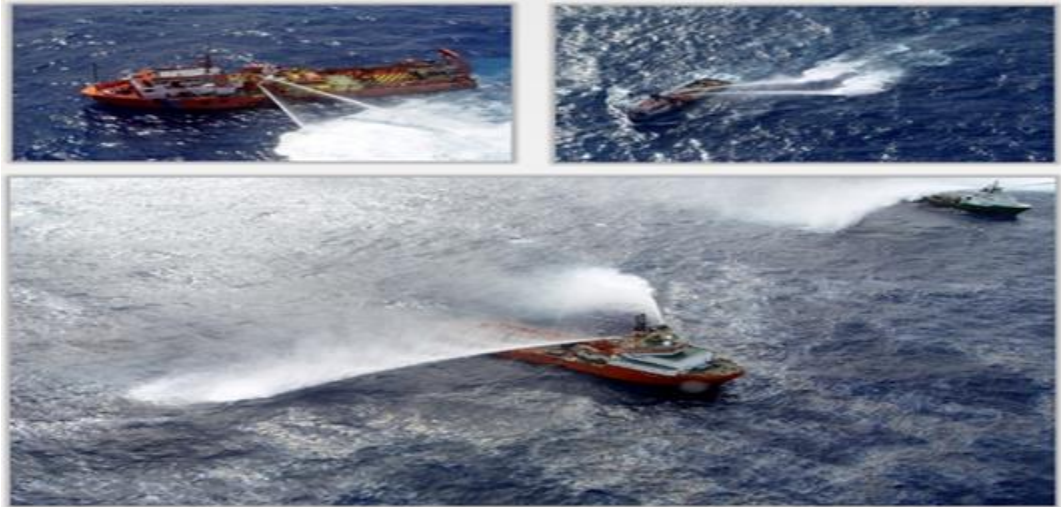
Figura 29: Embarcação trabalhando na dispersão mecânica do óleo.
