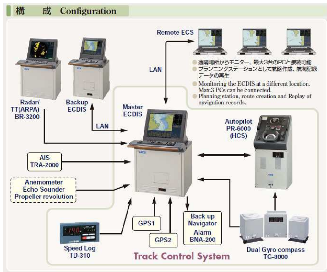
Figura 15- Esquema do ECDIS, mostrando o back-up e demais sensores que integram o sistema
