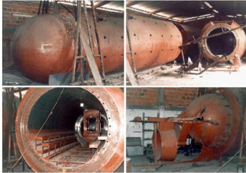
FIGURA 13 - Casco de um narcosubmarino em construção
