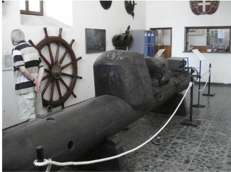
FIGURA 1 - Torpedo tripulado
