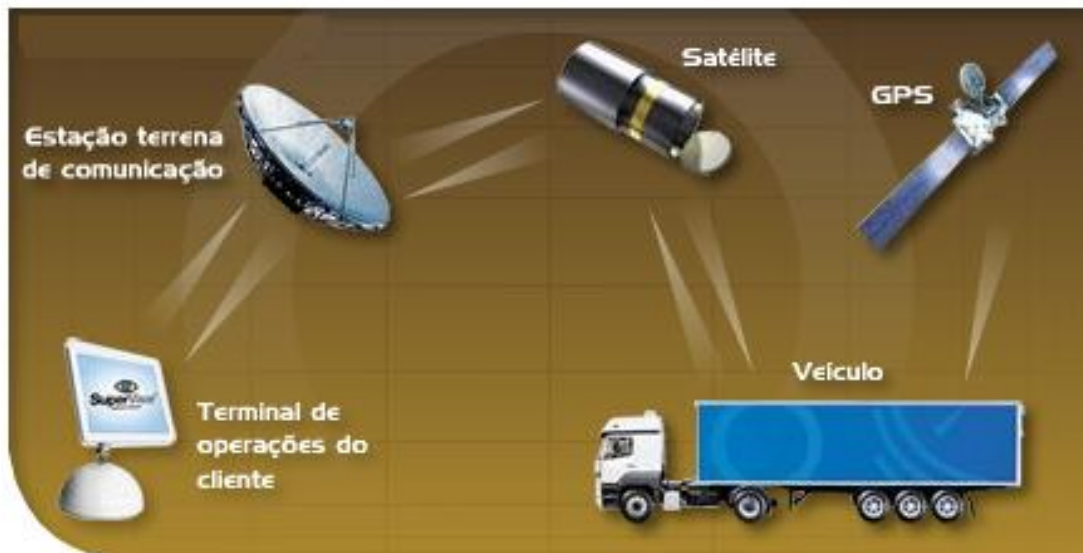
FIGURA 9 – Diagrama de funcionamento do sistema de rastreamento de veículos.
