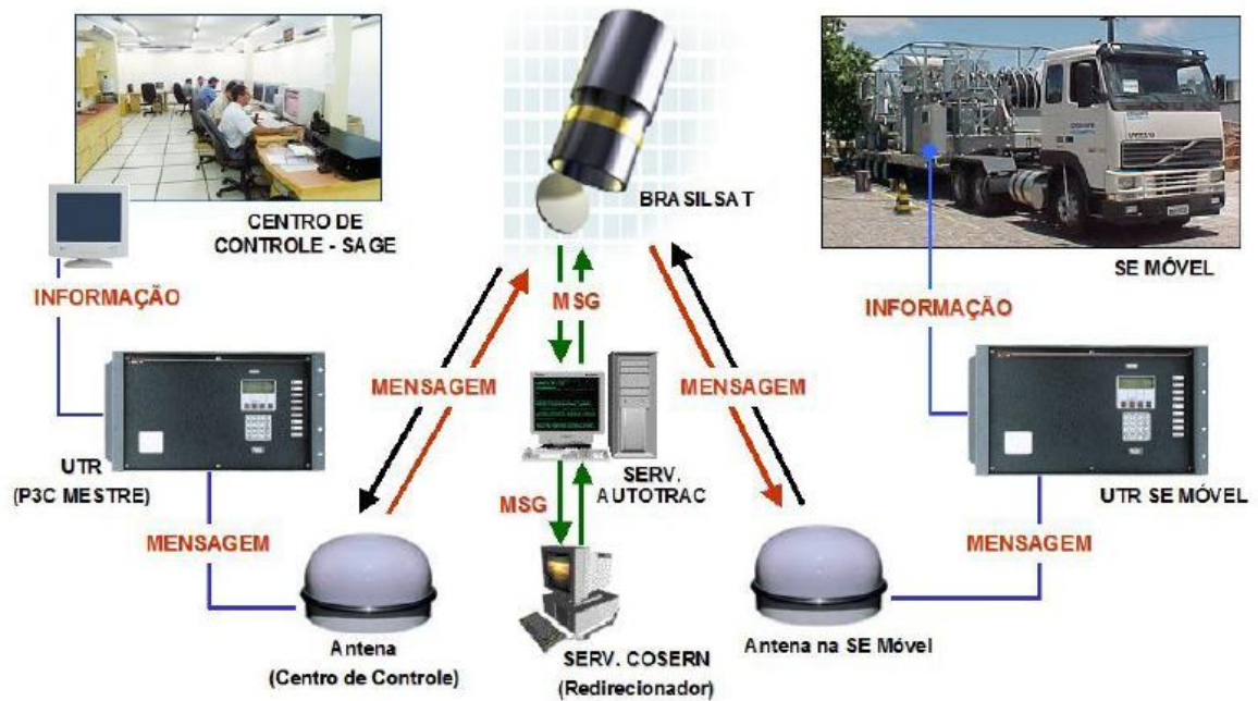
FIGURA 10 – Sistema de monitoramento e controle de estações elétricas móveis Fonte: OLIVEIRA JÚNIOR, 2005
