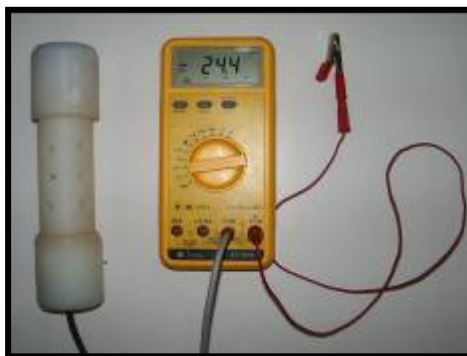
Figura 19 – Detalhe do multímetro e do eletrodo de referência Ag/AgCl.
