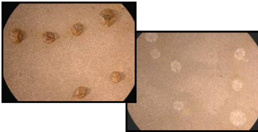
Figura 83 – Fotografia feita no microscópio estereoscópico mostrando os indivíduos e suas bases aderidas aos corpos-de-prova.
