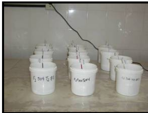
Figura 22 – Montagem dos corpos-de-prova dos três aços nos recipientes durante o assentamento.
