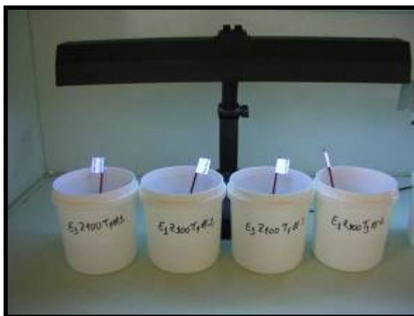
Figura 24 - Montagem dos corpos-de-prova do tratamento “Controle” sob irradiação de luz ultravioleta.
