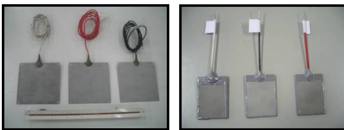
Figura 11 - Corpos-de-prova utilizados nos experimentos de campo e laboratório, após laminação a quente e corte indicados acima.
