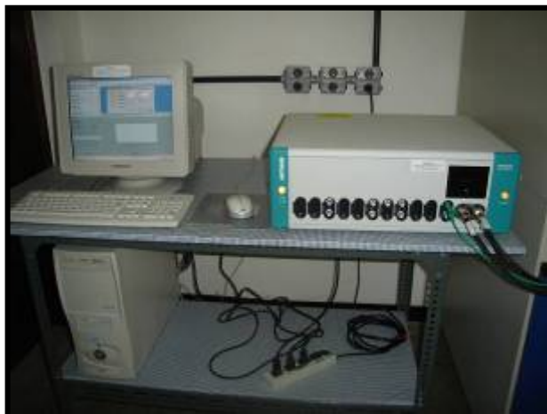
Figura 27 – Foto mostrando o equipamento Autolab PG30.
