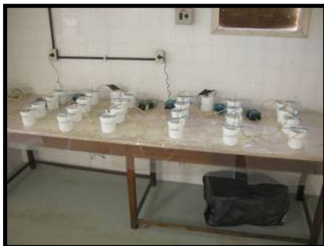
Figura 23 – Esquema da montagem com a aeração forçada.
