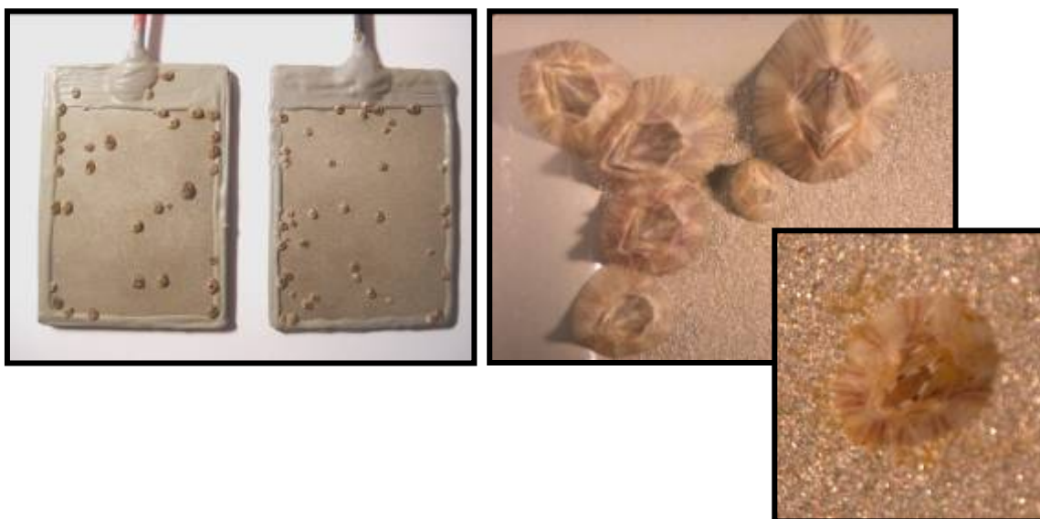
Figura 64 – Fotografia mostrando corpos-de-prova dos dois aços utilizados com os organismos fixados, à direita em detalhe e abaixo um indivíduo com o opérculo aberto.
