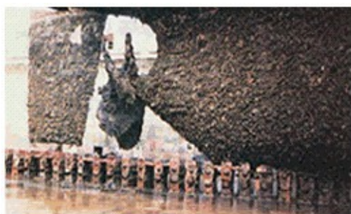
Figura 3. Docagem devido a incrustações. Fonte: www.cqjournal.com
