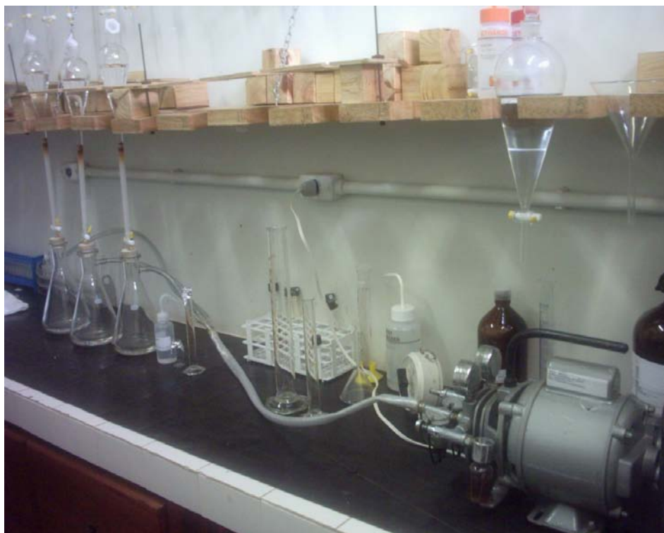
Figura 43. Sistema utilizado para fracionamento sob vácuo.
