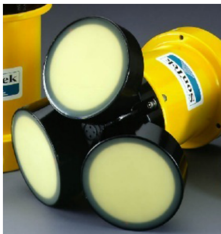
Figura 3.1: ADCP da Sontek [Sontek/YSI, 2005] utilizado nos cruzeiros oceanográficos dentro do CSS.
