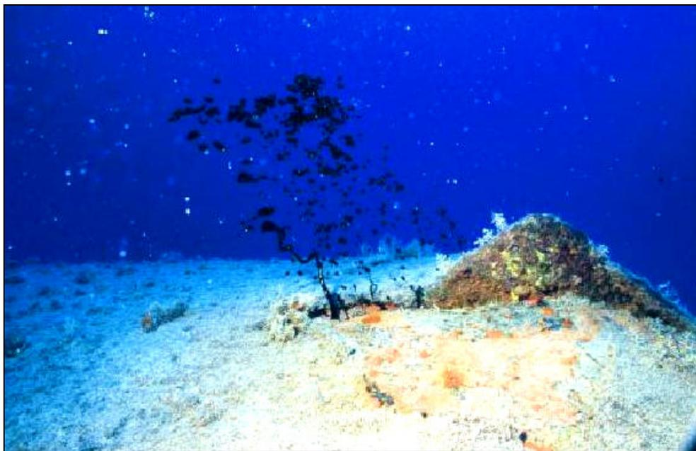
Fig. 2.2 – Vazamento de óleo através de rachadura no casco soçobrado do navio tanque da marinha norte-americana USS *Mississinewa*, observado em setembro de 2001 (MICHEL et al, 2005).
