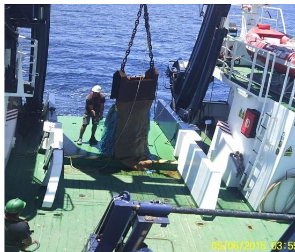
Fig. 5. Maniobras durante la recogida de una draga de arrastre realizada durante la campaña VULCANA 0515.
