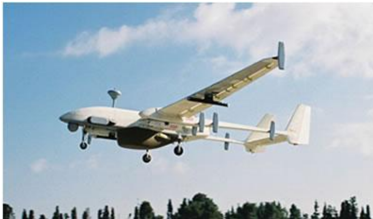
FIGURA 5. VANT Heron-1 equipado com radar de busca marítima. Fonte: ISRAELI WEAPONS 2008.
