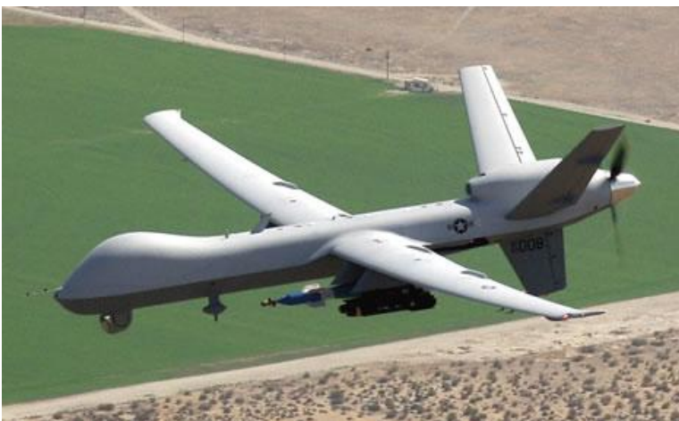
FIGURA 3. VANT Predator B/MQ-9 Reaper armado com bomba guiada a laser e mísseis Hellfire . Fonte: DEFENSE UPDATE 2008
