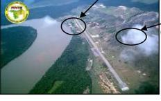
LARGO 2.400 MTS. CONSTRUIDA CON PIEDRAS DE MÁRMOL Y RECUBIERTA CON ASFALTO.
