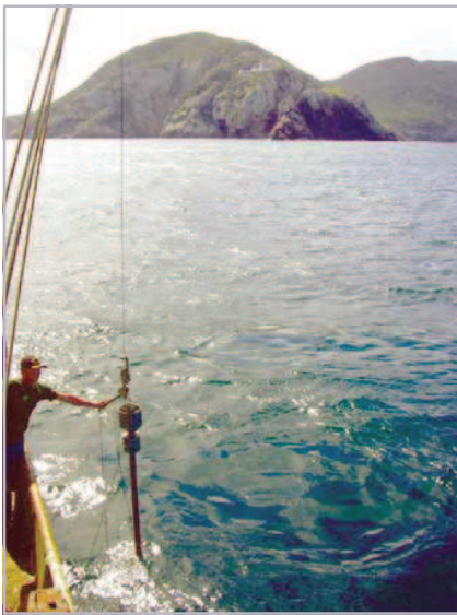
Figura 2 – Testemunhador a pistão, tipo Kullemerger, sendo operado do AvPqOc Diadorim na área de pesquisa. Ao fundo, a Ilha do Cabo Frio e o Farol.
