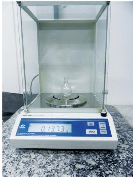
**FIGURA 3** - Pesagem da amostra.
