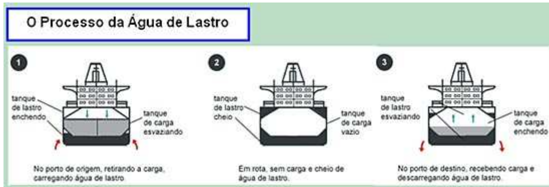
Fig 1. Procedimento de troca de lastro
